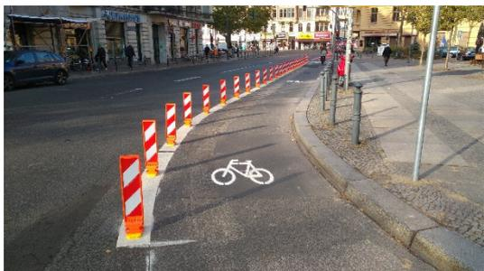
Radverkehrsanlage bei sehr hohen Verkehrsmengen im Kfz- und Radverkehr, *aktueller Entwicklungstrend in Großstädten*, keine Anwendungsfälle in Limbach-Oberfrohna.
