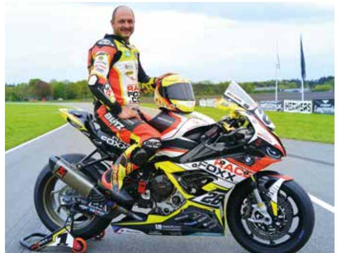
Grams' Vierzylinder-Viertakt-Rennmaschine hat 1000 ccm Hubraum und leistet über 200 PS. (Foto: Lutz Gerber).
